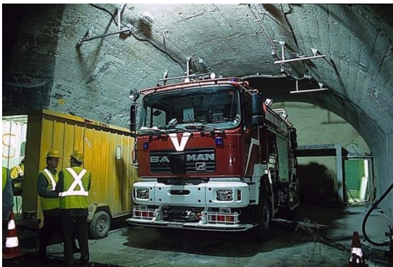
Figur 14 og 15: Redningsstation indbygget i Mont Blanc tunnelen (F/I) med specialbygget redningskøretøj.
